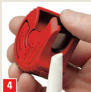
Schneidwerk herunterdrücken. Die Kartuschenspitze wird exakt und sauber abgetrennt.
