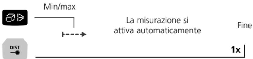
Sul display LC vengono visualizzati il valore massimo (max.), quello minimo (min.) e il valore attuale.
