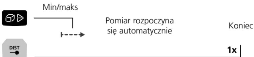
Wyświetlacz LC wskazuje największą (max), najmniejszą (min) i aktualną wartość.
