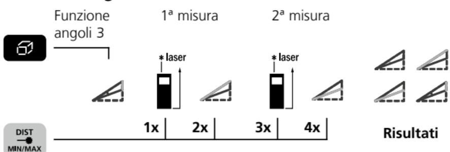
Il risultato di misurazione viene determinato automaticamente dal sensore di inclinazione a 360°.
