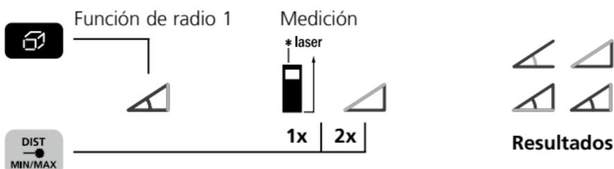
El resultado de medición se obtiene con el sensor de inclinación de 360°.
