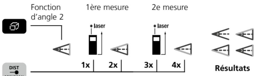
Les résultats de mesure sont calculés automatiquement par le capteur d'inclinaison 360°.
