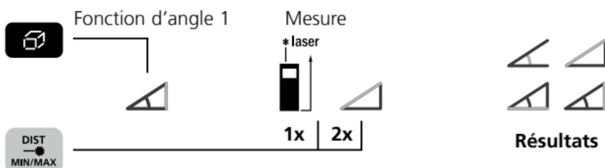
Les résultats de mesure sont calculés automatiquement par le capteur d'inclinaison 360°.
