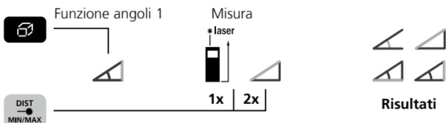
Il risultato di misurazione viene determinato automaticamente dal sensore di inclinazione a 360°.
