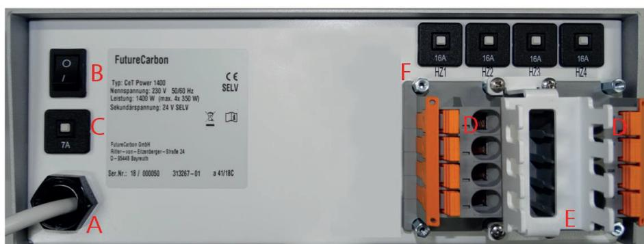
Abbildung 1: Übersicht der Spannungsversorgung CeT Power 1400
