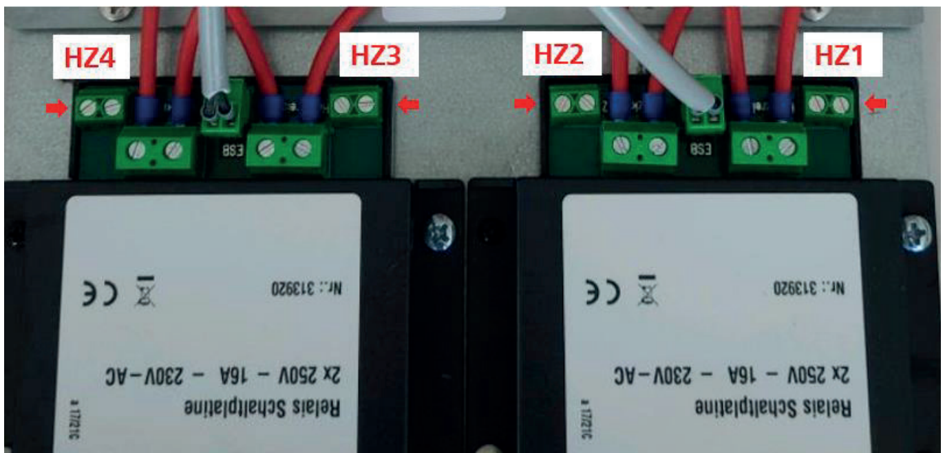
Abbildung 4: Anschluss der 230 V Steuerleitungen der Thermostate für die jeweiligen Heizzonen am Beispiel der Spannungsversorgung CeT Power 1400 UP-4xES mit 4 Heizzonen. Die Heizzonenbeschriftung korrespondiert mit der Nummerierung der folgenden Abbildungen.
