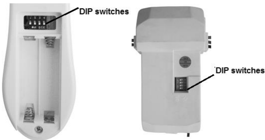
Fig. 1 Compartiment à piles de la télécommande Récepteur
