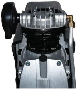
Öl-Einfüllverschraubung mit Entlüftung
