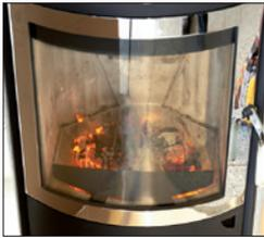
Sekundärluft: Komplett geöffnet ("MAX")
