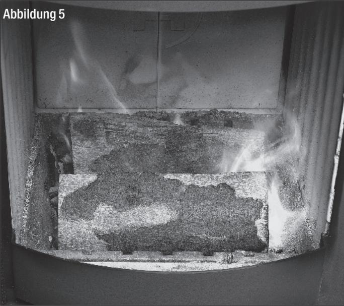
Sind auch diese Holzstücke rundherum angebrannt, sollten Ofen und Abgassystem weitgehend die Betriebstemperatur erreicht haben. Jetzt können Sie den Primärluftregler schließen und die Verbrennung hauptsächlich über den Sekundärluftregler regeln. Für eine optimale Verbrennung sollten Sie den Sekundärluftregler immer mindestens 50 % geöffnet lassen (Abb. 6).
