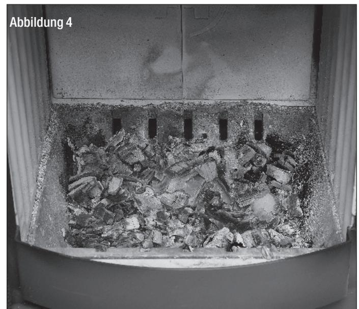
Je nach Holzgüte, Schornsteinzug und Witterung dauert diese Verbrennungsphase unterschiedlich lange. Legen Sie jetzt zwei weitere Holzscheite parallel zur Feuerraumscheibe auf und verschließen die Feuerraumtür (Abb. 5).
