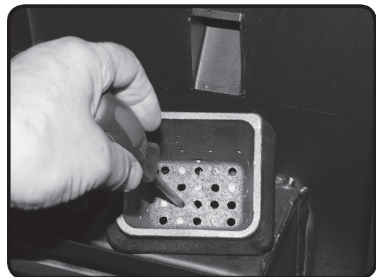
Abb. 14c: Reinigung der Luftöffnungen mit einem Werkzeug
