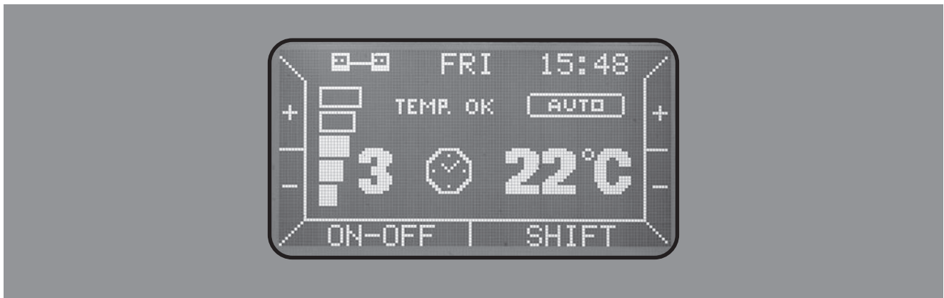
Abb. 11: Display-Anzeige bei Automatikbetrieb
