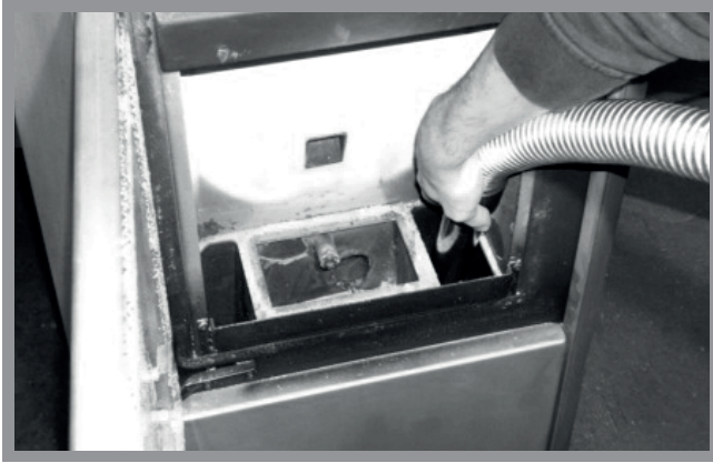
Abb. 12g: Reinigung untere Brennkammer
