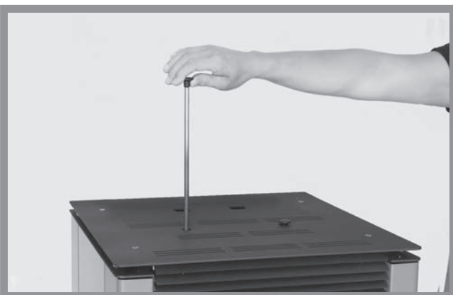
Abb. 12e: Reinigung der Wärmetauscher
