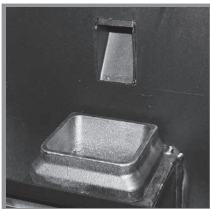
Abb. 6b: Richtig eingesetzter Brenntopf
