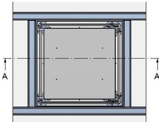
Rahmen aus CD-Profilen umlaufend als Wechsel erstellen, Abstand zum Außenrahmenprofil ca. 5 mm.
