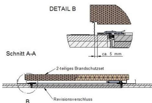
2-teiliges Brandschutzset spaltfrei auf CD-Profil auflegen und Türblatt verschließen. **Nur dann ist der Brandschutz gewährleistet!**
