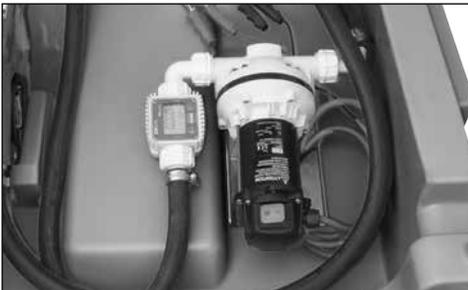
Non è possibile evitare le piccole perdite o la caduta di gocce di soluzione urea che causano il deposito di urea bianca cristallizzata. Pulire pertanto l'apparecchiatura specialmente la pistola erogatrice, se necessario, con acqua tiepida. Non deve penetrare acqua da bere nel serbatoio poiché non corrisponde alle esigenze di pulizia. Per pulire la parte interna del serbatoio è consentito utilizzare solo acqua demineralizzata.
