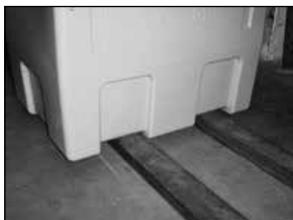
I tomt tillstånd kan Blue-Mobil Easy bäras i greppskålarna på framsidan och på sidan. Behållaren har fickor för gafflar undertill. Max. tre tomma behållare eller två fulla behållare får staplas på varandra. Behållaren har fyra klackar upptill för säker fastlåsning.
