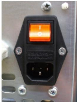
Fig. 50 - Elektrische Steckdose mit Hauptschalter
