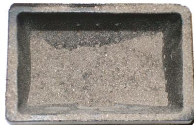
Fig. 72 - BEISPIEL VERSCHMUTZTE BRENNSCHALE
