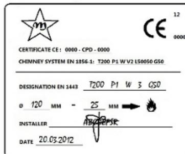
Fig. 3 - Beispiel für Typenschild
