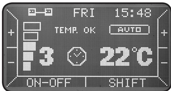
Abb. 13: Display-Anzeige bei Automatikbetrieb
