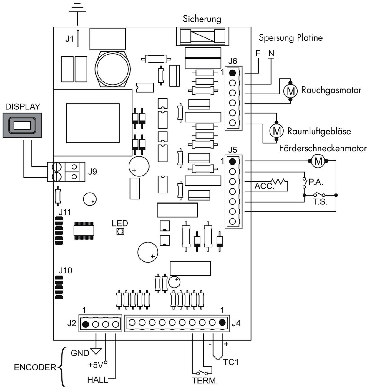
Abb. 16: Schaltplan der Platine
