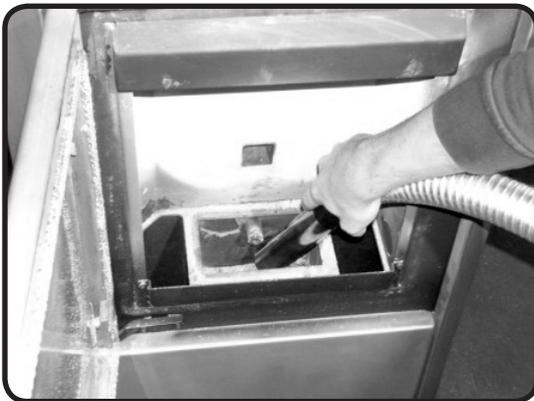
Abb. 14f: Reinigung Brennraumbehälter
