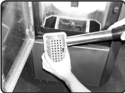
Abb. 14b: Reinigung der Luftöffnungen mit einem Staubsauger
