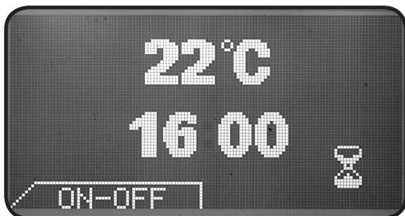
Abb. 9: Display-Anzeige während der Abkühlphase
