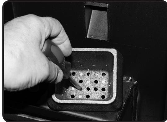
Abb. 14c: Reinigung der Luftöffnungen mit einem Werkzeug
