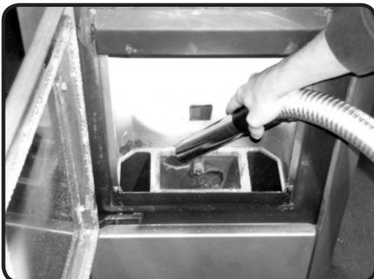
Abb. 14d: Reinigung der Topfhalterung
