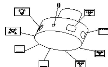
Zur Einstellung der Temperatur bewegen Sie den Drehschalter für die Temperaturkontrolle des Ofens auf die gewünschte Einstellung. Sie können hierbei eine Temperatur von 50°C – 250°C wählen.
