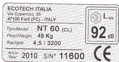
CE TYPENSCHILD DER MASCHINE.
