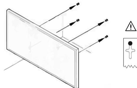
4. Infrarot-Heizpaneel in alle 4 Schrauben einhängen, Schraubenköpfe müssen in Schlitz eingeschoben werden.
