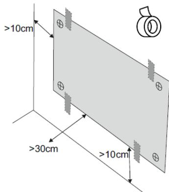
1. Position auswählen (Mindestabstände beachten), Bohrschablone befestigen, Pos. der 4 Löcher markieren. Montage ist im Hoch- oder Querformat möglich.
