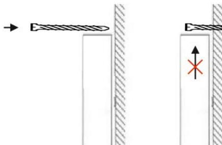
5. Schraube oder Nagel oberhalb der Oberkante in der Wand befestigen, um das Paneel gegen unabsichtliches Anheben zu sichern.
