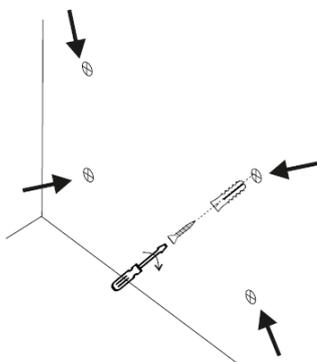
3. Dübel einsetzen, Schrauben in Dübel einschrauben, Schrauben sollten noch ca. 5mm aus der Wand ragen.
