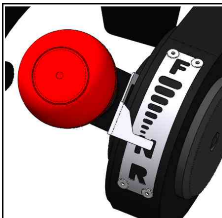
Obr. 8: Polohy páčky akcelérátoru
