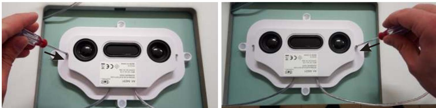
**5) NUN VERBINDEN SIE DIE BLUETOOTH BOX AN DEN TRAFU UND DAS LED BAND DER SPIEGEL IST WIEDER FUNKTIONSFÄHIG:**
