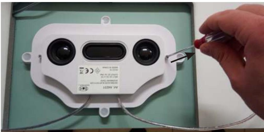
**4) NUN KANN DIE BLUETOOTH BOX ENTFERNT WERDEN UND DIE NEUE MIT ZWEI SCHRAUBEN AM SPIEGEL FIXIERT WERDEN:**
