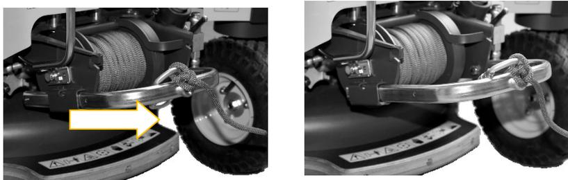
8) Heben Sie den Mäher auf der Windenseite an der Windenführung an, bis der Griff für die Mähhöhe auf dem Boden aufliegt.
