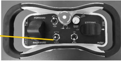
5) Drücken Sie den NOT-AUS an der Steuerung und dann auf dem Mäher.
