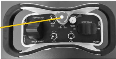
6) Der Hauptschalter muss am Ende des Arbeitszyklus oder bei unbeaufsichtigtem Betrieb des Mähers ausgeschaltet werden.
