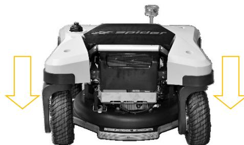
7) Ziehen Sie die Windenführung in Ihre Richtung. Es wird teilweise ausgeworfen. Dies gibt Ihnen einen größeren Hebel, um die Maschine in die Wartungsposition zu bringen.
