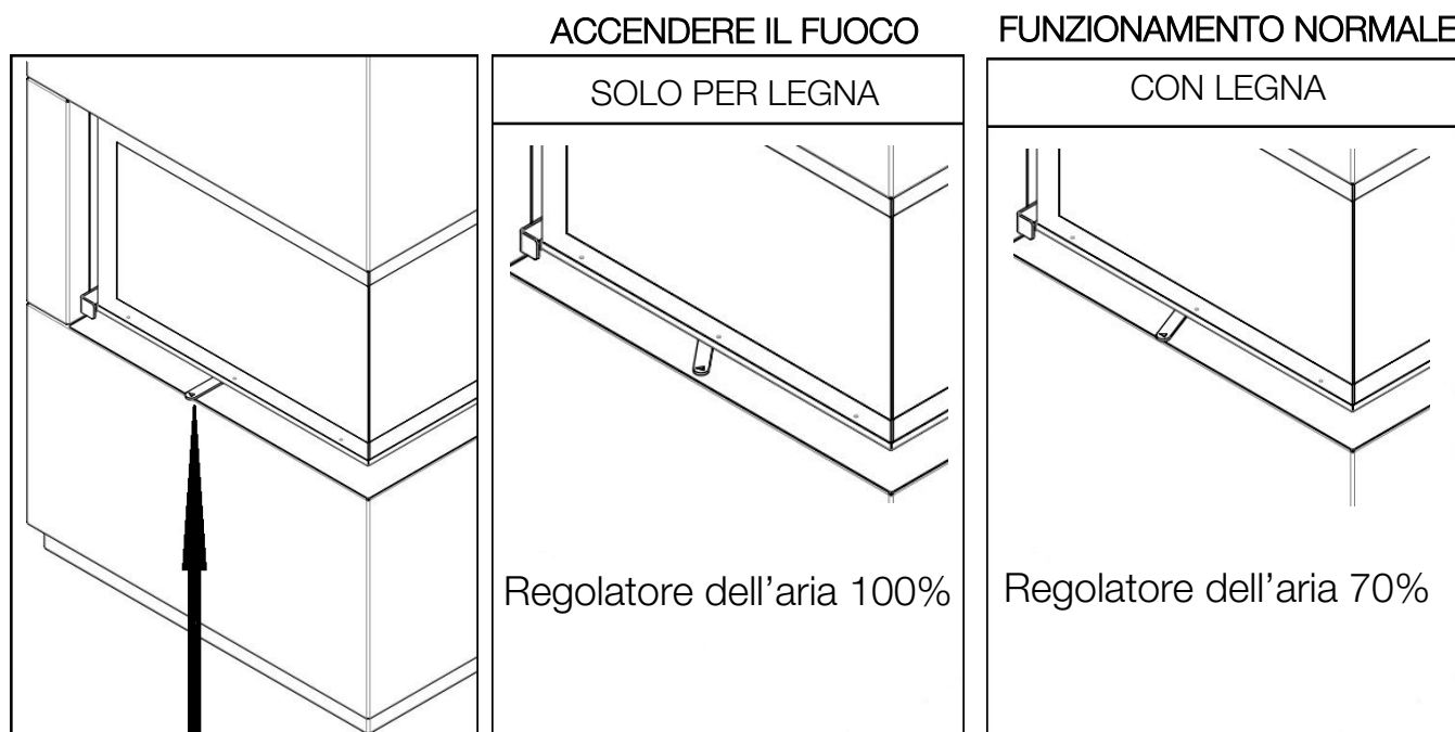
Regolatore dell'aria Figura 7 – Utilizzo del regolatore dell'aria
