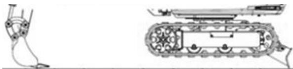
Zum Ausfahren des Fahrwerks heben Sie die Maschine mithilfe des Auslegers, des Arms, des Schildes und des Löffels vorsichtig an. Achten Sie dabei darauf, dass die Maschine auf einem festen, ebenen Untergrund steht und ein
