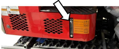
Die Anzeige für den Füllstand des Hydrauliktanks befindet sich an der rechten Seite des Oberwagens. Achten Sie darauf, dass das Öl bis zur Mitte des Markierungsbereichs eingefüllt wird. Beachten Sie dabei, dass sich das Öl während des Betriebs erhitzt und ausdehnt.
