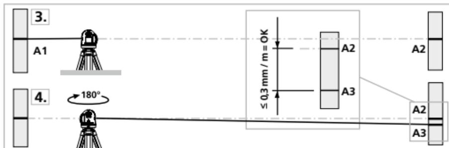
**!** Om A2 och A3 ligger mer än  $0,3 \text{ mm / m}$  från varandra behöver enheten justeras. Kontakta er återförsäljare eller vänd er till serviceavdelningen på UMAREX-LASERLINER.
