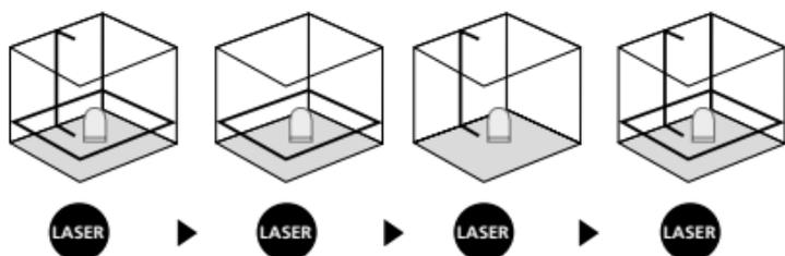
Pro horizontální a vertikální nivelaci musí být uvolněna transportní pojistka. LED svítí nepřerušovaně zeleně. Jakmile se přístroj nachází mimo rozsah automatické nivelace 4°, blikají laserové linie a LED se rozsvítí červeně. Umístěte přístroj tak, aby se nacházel uvnitř rozsahu nivelace. LED se opět rozsvítí zeleně a laserové linie svítí nepřerušovaně.
