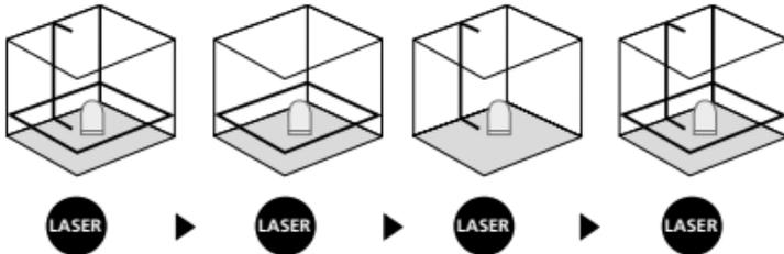
Для горизонтального і вертикального нівелювання необхідно розфіксувати транспортне стопоріння. Постійно світиться зелений світлодіод. У разі виходу за межі діапазону автоматичного нівелювання, що становить  $4^\circ$ , лазерні лінії починають блимати, а світлодіодний індикатор загоряється червоним світлом. Розташуйте прилад так, щоб він потрапив у межі діапазону автоматичного нівелювання. Світлодіод знову змінить колір на зелений, а лазерні лінії загоряться сталим світлом.
