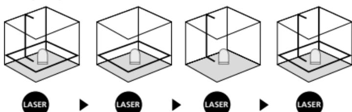
**!** Para a nivelção horizontal e vertical é preciso que o bloqueador de transporte esteja solto. O LED acende constantemente com cor verde. Logo que o aparelho se encontre fora da área de nivelção automática de 4°, as linhas de laser piscam e o LED acende com cor vermelha. Posicione o aparelho de modo a que se encontre dentro da área de nivelção. O LED volta a mudar para verde e as linhas de laser acendem constantemente.
