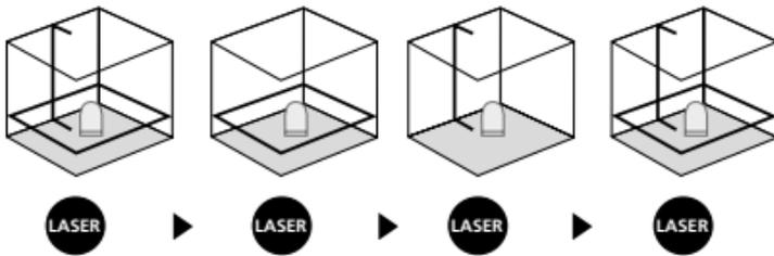
Vid horisontell och vertikal nivellering måste transportsäkringen lossas. Lysdioden lyser konstant grön. Så fort enheten befinner sig utanför det automatiska nivelleringsområdet på 4°, blinkar laserlinjerna och lysdioden tänds i röd färg. Positionera enheten på ett sådant sätt, att den befinner sig inom nivelleringsområdet. Lysdioden växlar över till grön igen och laserlinjerna lyser konstant.
