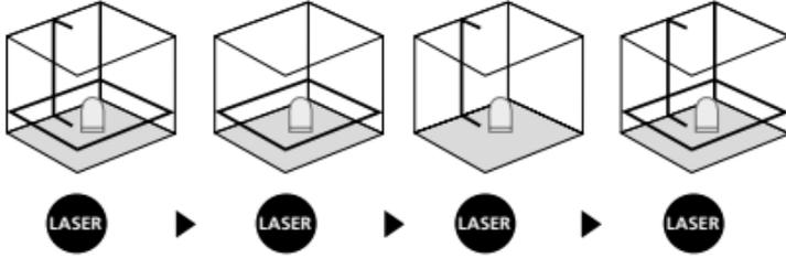
! Yatay ve düşey düzeçleme için taşıma emniyetinin çözülmüş olması gerekmektedir. LED sabit şekilde yeşil yanar. Cihaz otomatik düzeçleme aralığı olan 4°'nin dışında bulunduğu zaman, lazer çizgileri yanıp sönmeye başlarlar ve LED kırmızı yanar. Cihazı düzeçleme aralığı içinde bulunacak şekilde konumlandırınız. LED yine yeşile döner ve lazer çizgileri sabit yanarlar.
