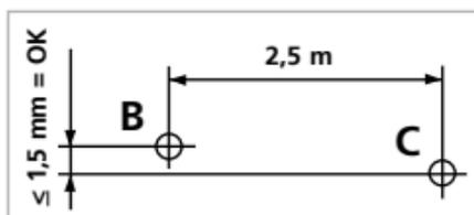
Сделайте отметку B на стене. Поворачивайте прибор, пока лазерный крест не сдвинется на 2,5 м вправо. Сделайте отметку C. Расстояние между горизонтальными линиями, проведенными через эти две точки, не должно превышать  $\pm 2$  мм. Повторите замеры, поворачивая прибор влево.
