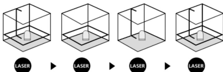
Horisontal og vertikal nivellering krever at transportsikringen løsnes. LED-en lyser konstant grønt. Straks apparatet befinner seg utenfor det automatiske nivelleringsområdet på 4°, blinker laserlinjene og LED-en lyser rødt. Posisjoner apparatet slik at det befinner seg innenfor nivelleringsområdet. LED-en lyser grønt igjen og laserlinjene lyser konstant.
