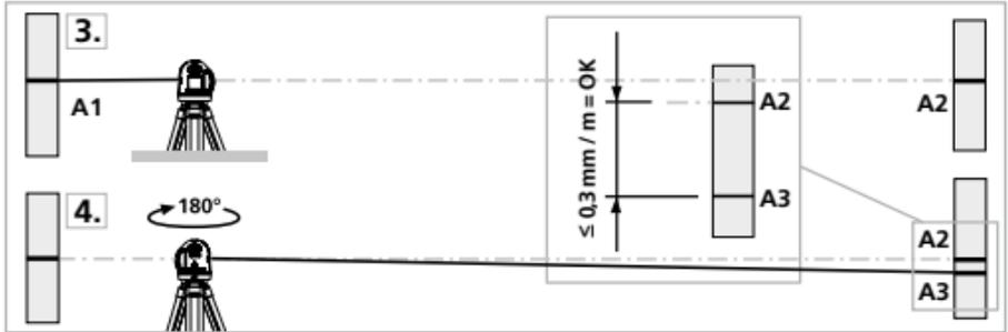
**!** Jos A2 ja A3 ovat toisistaan etäämmällä kuin  $0,3 \text{ mm / m}$ , on säätö tarpeen. Ota yhteys paikalliseen laitetoimittajaantai UMAREX-LASERLINER huolto-osastoon.
