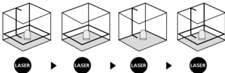
**!** Vaaka- ja pystysuuntaan tasaamista varten tulee kuljetusvarmistuksen olla vapautettuna. Punainen LED-valo palaa jatkuvasti vihreänä. Kun laite on automaattisen tasausalueen 4° ulkopuolella, laserviivat vilkkuvat ja punainen LED-valo syttyy. Sijoita laite tasaiselle alustalle niin, että laite on tasausalueella. Vihreä LED-valo syttyy ja laserviivat palavat jatkuvasti.
