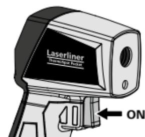
Прилад вимикається автоматично через 30 секунд простою. Для повторного ввімкнення приладу слід знову натиснути кнопку.
