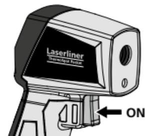
A készülék 30 másodperc után automatikusan kikapcsol. A készülék ezt követő újból bekapsolásához nyomja meg újból a gombot.
