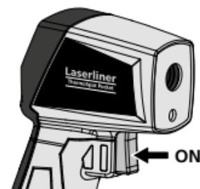
Naprava se po 30 sekundah samodejno izključi. Da bi napravo po tem ponovno vključili, znova pritisnite tipko.
