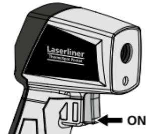
El aparato se apaga automáticamente a los 30 segundos. Para encenderlo, pulse de nuevo el botón.
