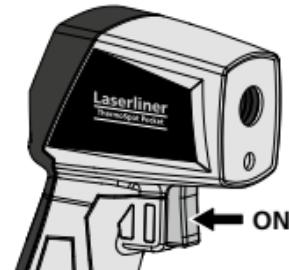
Instrumentet slår seg automatisk av etter 30 sekunder. For deretter å slå instrumentet på igjen, må det trykkes på knappen igjen.
