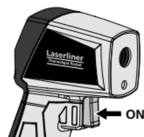
Apparatet slukker automatisk efter ca. 30 sekunder. For at tænde for apparatet igen, skal du trykke på tasten igen.
