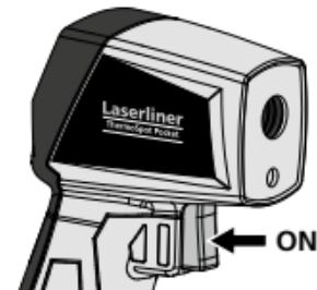
Het toestel schakelt na 30 seconden automatisch uit. Druk opnieuw op de toets om het toestel daarna weer in te schakelen.
