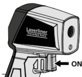
Das Gerät schaltet sich nach 30 Sekunden automatisch ab. Um das Gerät danach wieder einzuschalten, Taste erneut drücken.
