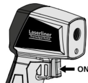
Instrumentet stängs av automatiskt efter 30 sekunder. Tryck på knappen igen för att åter slå på enheten.
