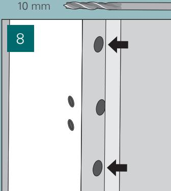
**DE** Verwenden Sie einen 10 mm Bohrer. Wenn Sie dickere Schrauben verwenden, passen Sie den Ø des Bohrers der Schraubengröße an.
