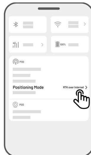
3. Wählen Sie **RTK über Datenverbindung** und achten Sie darauf, dass die angezeigte Datenverbindungsnummer mit der Nummer auf dem Typenschild der RTK-Referenzstation übereinstimmt. Falls nicht, geben Sie die korrekte Nummer ein. Tippen Sie auf **OK**.
