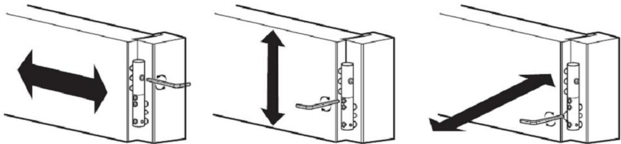
Der Druck des Flügels auf der Schlossseite kann durch die Änderung der Lage des Riegelbleches des Hauptschlusses geändert werden, indem man zwei Schrauben einstellt, die sich in der Riegeleinlage befinden, und das Blech verschiebt. Nach der Einstellung sind die Schrauben festzuziehen.
