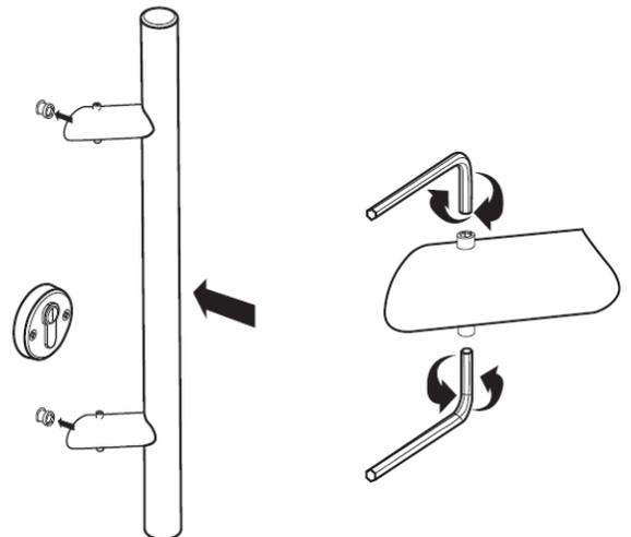
Der Türdrücker und der Profilzylinder sind mit den beigefügten Schrauben anzuschrauben. Die Zierabdeckungen sind danach anzubringen. Bei unterer Rosette erst Profilzylinder montieren, dann von beiden Seiten Schaumdichtung aufziehen und danach die Rosette und Zierabdeckung montieren. Nach der Montage der Profilzylinderrosette der Türschloss soll leicht schließen, falls schwer geht, die Montage der Rosette korrigieren.
