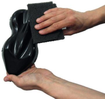
Reinigen Sie das zu beschichtende Teil mit Wasser und etwas Spülmittel von groben Verschmutzungen. Schleifen Sie anschließend das Teil mit einem der Oberfläche geeigneten Schleifmedium an. Bei bereits lackierten Flächen reicht ein Schleifvlies. Reinigen Sie das Teil mit einem fusselreichen Tuch (staubfreie Oberfläche).
