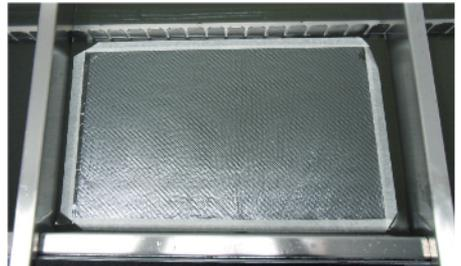
**TIPP:** Nehmen Sie die Wassertransferdruckfolie an zwei diagonal gegenüberliegenden Ecken und legen Sie diese so auf die Wasseroberfläche, dass sich keine Luftblasen unter der Folie bilden können! Am Besten gelingt das, wenn die Folie an dem Klebebandrahmen gehalten und leicht gespannt wird. Nun wird eine Ecke der Folie vorsichtig auf der Wasseroberfläche aufgelegt. Dann die restliche Folie langsam auf die Wasseroberfläche gleiten lassen.
