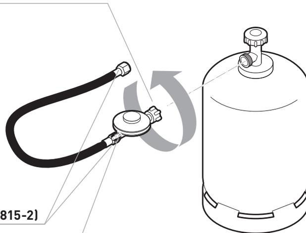
**Überwurfmutter des Schlauches (DIN 4815-2)**
