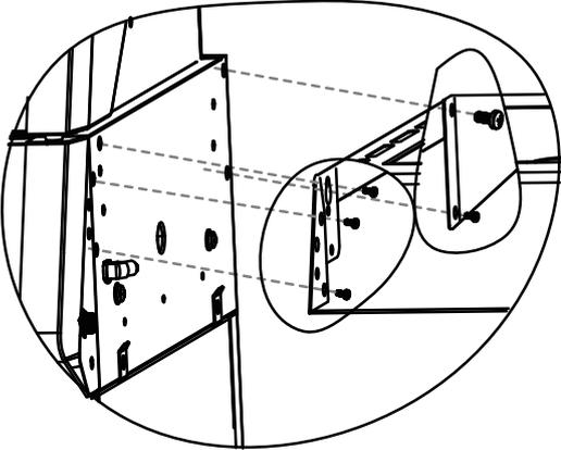
**④ Befestigen Sie die 2 Schrauben an der Feuerbox**
