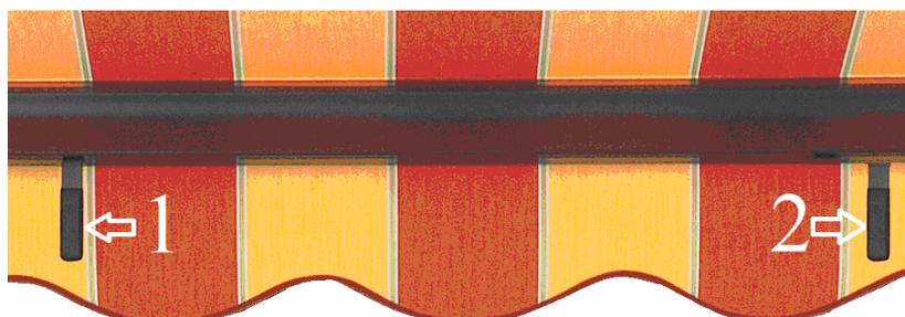
Bei der Hülsenmarkise Elegance sind am Ausfallprofil 2 Stahlwinkel (Armanschläge) montiert. Es handelt sich hierbei nicht um eine Transportsicherung. Die Winkel dürfen nicht entfernt werden. Die Armanschläge nehmen, kurz bevor die Markise schließt, die Gelenkarme gleichmäßig mit zurück und verhindern zudem, dass die Arme im eingefahrenen Zustand ausklappen können.
