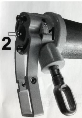
1. Feststellschraube mit 4er Inbuss (1) lösen
