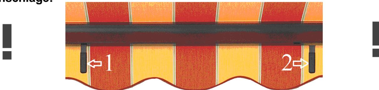
Bei der Hülsenmarkise Elegance sind am Ausfallprofil 2 Stahlwinkel (Armanschläge) montiert. Es handelt sich hierbei nicht um eine Transportsicherung. Die Winkel dürfen nicht entfernt werden. Die Armanschläge nehmen, kurz bevor die Markise schließt, die Gelenkarme gleichmäßig mit zurück und verhindern zudem, dass die Arme im eingefahrenen Zustand ausklappen können.
