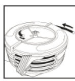
fig. 8 - mettre le nouveau tuyau en place
