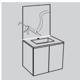
Zwischen dem Waschtischunterschrank und dem Rückwandspiegel muss unbedingt verfugt werden.
