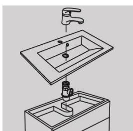
Le plan doit être compatible avec le meuble (installation des siphons et des bondes). En aucun cas le meuble ne doit être découpé pour faciliter la pose du meuble (plinthe, passage des évacuations, siphon,...).
