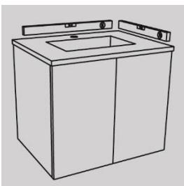
Le meuble doit être installé de façon plane et de niveau conformément aux préconisations de nos notices d'installations.
