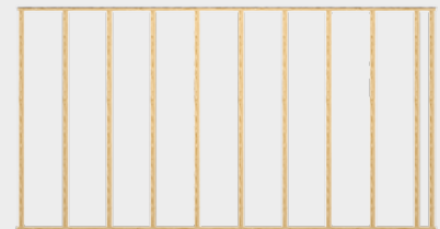
Achsabstand Unterkonstruktion max. 500 mm
