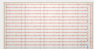
Verlegung der Heizrohre (16 mm)
