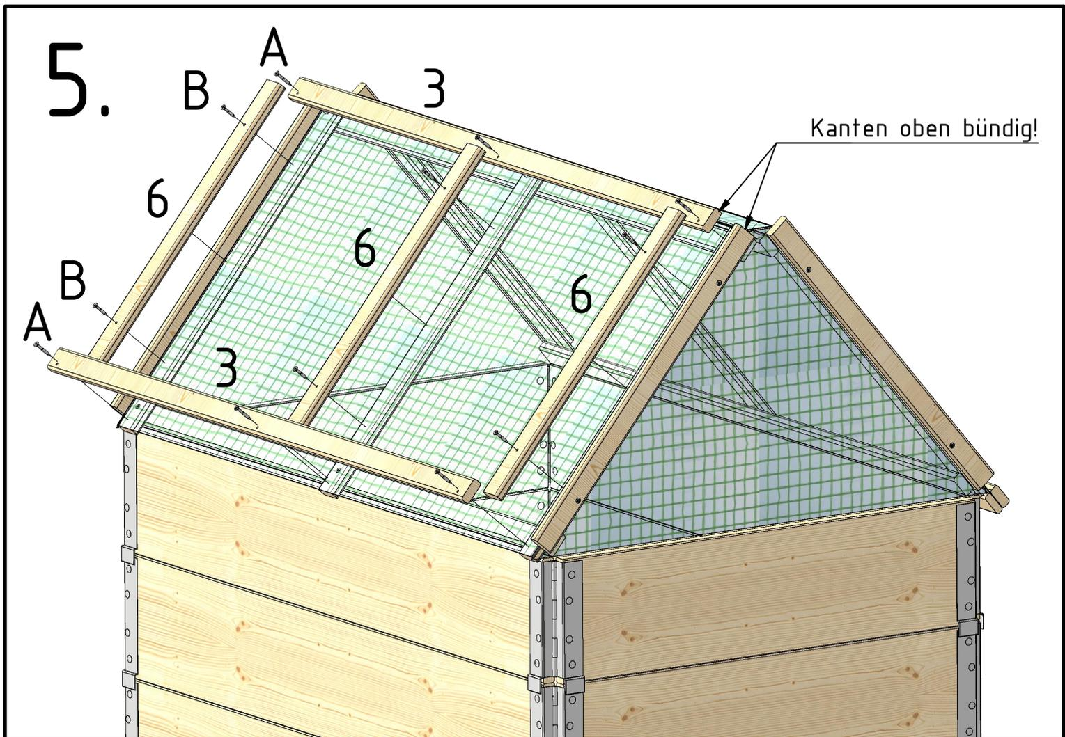
Die Gitterfolie (F) aus Schritt 4 auf das Gestell legen und mit Hilfe von doppelseitigem Klebeband ausrichten. Dann mit Leisten (3 + 6) und Schrauben (A + B) verschrauben!
