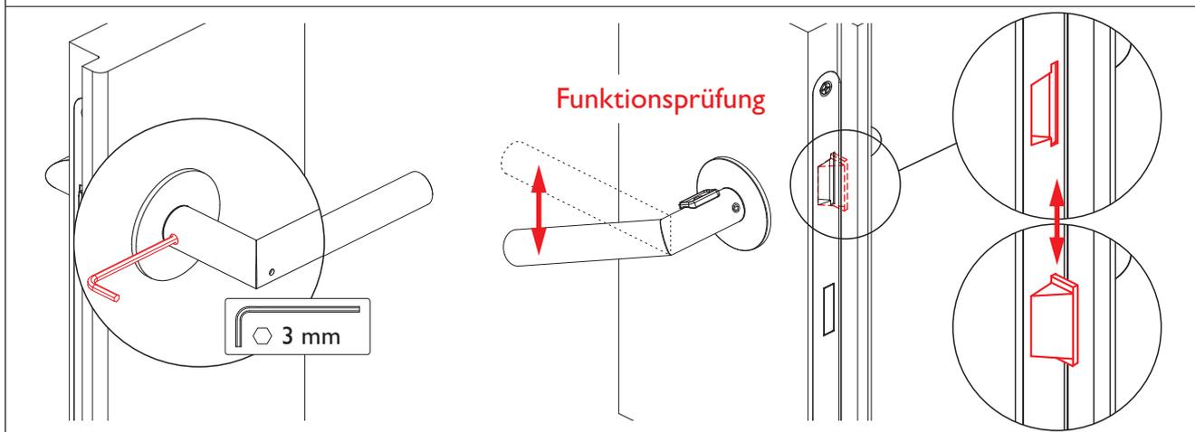
! Maximal 3 Nm Anzugskraft
