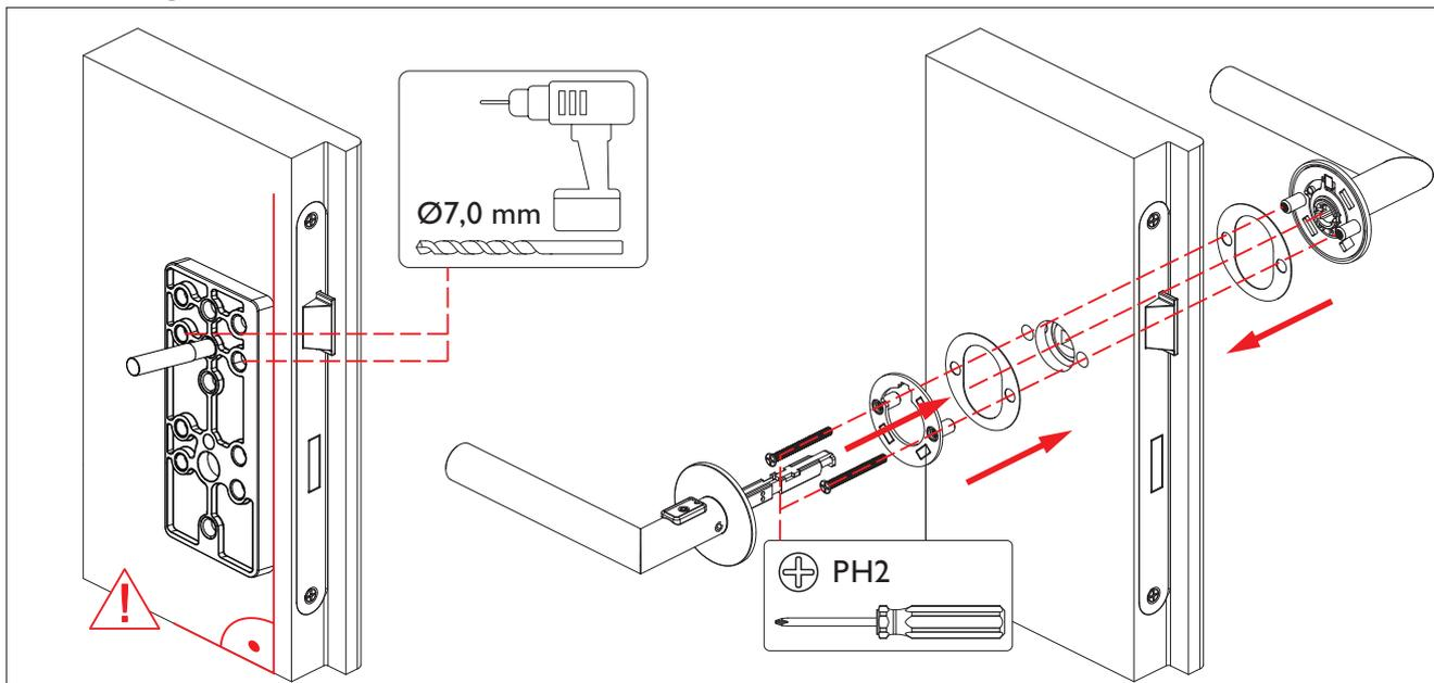
! Position des Verriegelungsschiebers im Auslieferungszustand belassen, bis zur Montage im Schloss!
