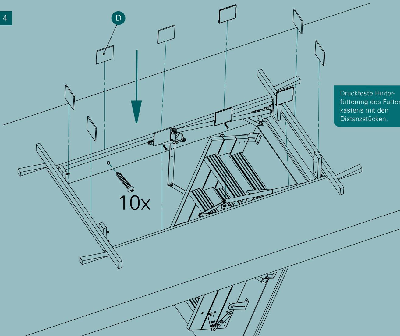
Druckfeste Hinterfütterung des Futterkastens mit den Distanzstücken.
