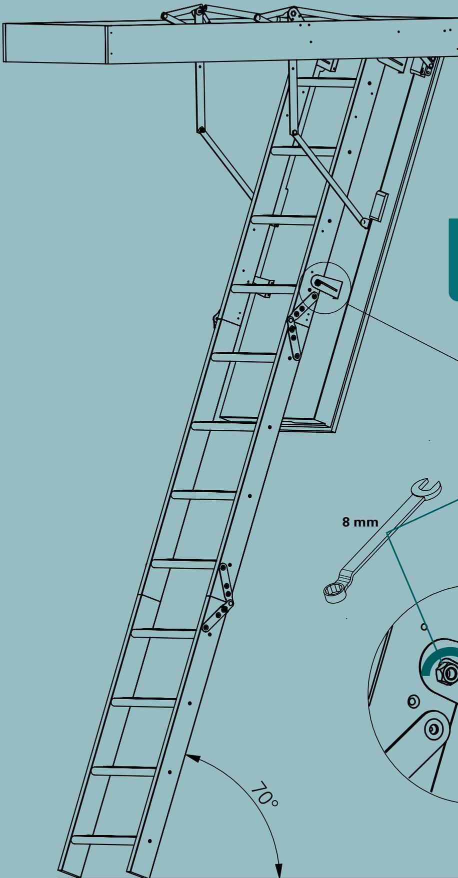
Treppenkast von der Transportstellung (unten) in die Funktionsstellung (oben) bringen. Dazu ist mit einem 8 mm Gabelschlüssel die Mutter zu lockern und nach dem Hochstellen wieder festzuziehen.
