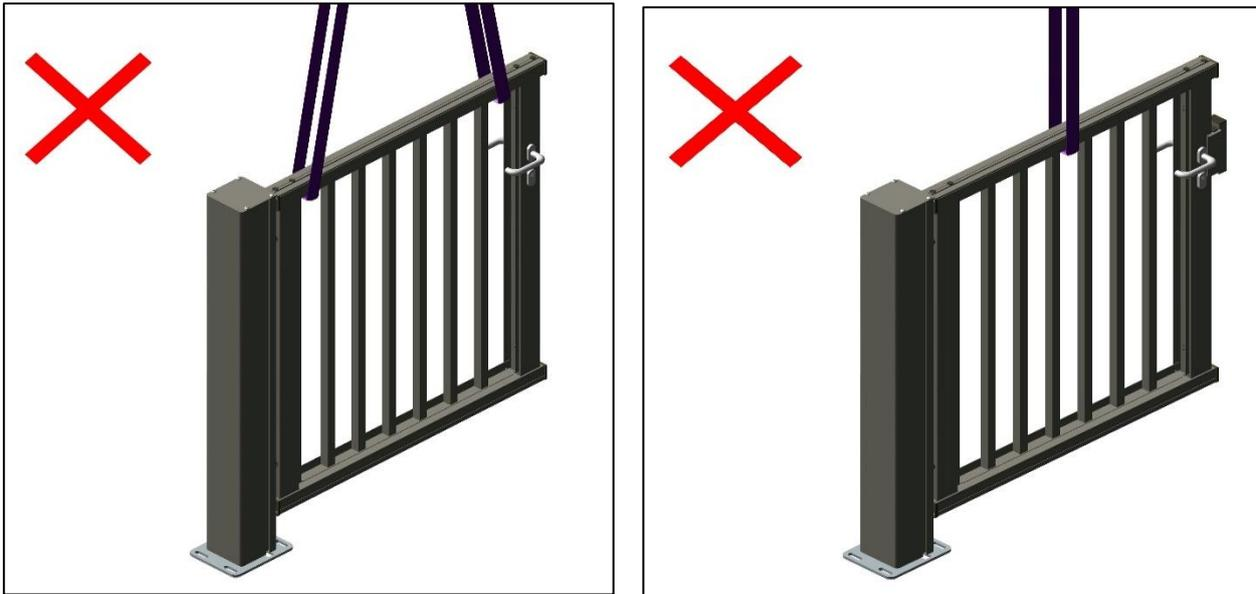
*Abbildung 3: Falsche Lastverteilung beim Heben*
