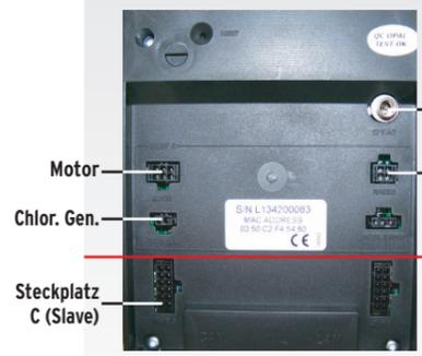
7. Auf der Rückseite der LEX Connect Steuerung können Sie jetzt die Steckverbindungen der zugeführten Kabel der zweiten Anlage mit dem vorgesehenen Steckplatz C (Slave) der unteren Ebene verbinden. Die Steckverbindungen der Master-Säule (A) sind nun ebenfalls an der oberen Ebene der LEX Connect Steuerung anzubringen. Beachten Sie die entsprechenden beschrifteten Steckerbelegungen.
