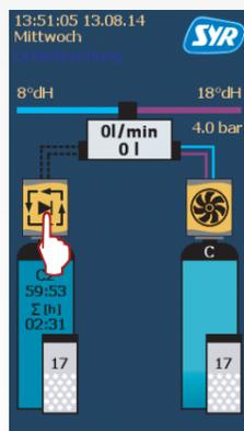
15. Mit dem Symbol „Play“ kann der Regenerationszyklus manuell verkürzt werden: Drücken Sie hierzu die „Play“ Taste. Der Zyklus C2 wird angezeigt. Jetzt können Sie mit „Play“ in der Reihenfolge alle Zyklen anwählen. Hiermit wird die Funktion manuell geprüft. Mit Zyklus C 10 endet dieser Vorgang.
