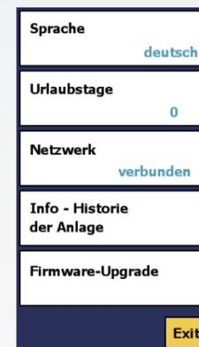
Sobald eine Internetverbindung entstanden ist, erkennen Sie dies an der Display-Anzeige in Ebene 1 – hierhin gelangen Sie durch einmaliges kurzes Berühren des Displays.
