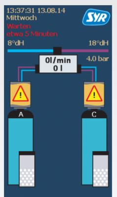
1. Für ca. 5 min. wird ein Selbsttest durchgeführt.
