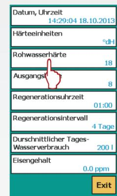
6. Wechseln Sie mit zum Punkt „Rohwasserhärte“ aus.
