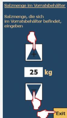
17. Addieren Sie die eingefüllte Salzmenge beider Behälter und geben Sie sie ein (kg). Bestätigen Sie den Wert mit „Exit“. Anschließend wird im Display der Salzvorrat angezeigt (noch verfügbare Menge in Wochen). **Hinweis:** Diese Angabe stellt nur einen Richtwert dar! Danach wird die Grundanzeige des Displays wieder erreicht.
