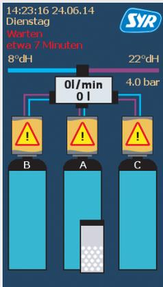
1. Für ca. 7 min. wird ein Selbsttest durchgeführt.
