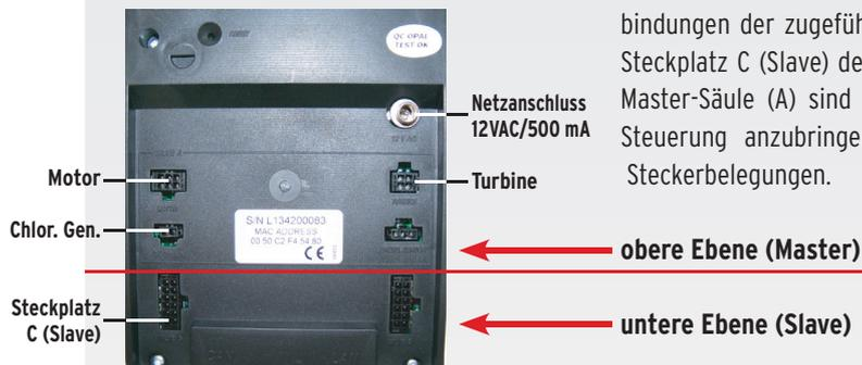
10. Auf der Rückseite der LEX Connect Steuerung können Sie jetzt die Steckverbindungen der zugeführten Kabel der zweiten Anlage mit dem vorgesehenen Steckplatz C (Slave) der unteren Ebene verbinden. Die Steckverbindungen der Master-Säule (A) sind nun ebenfalls an der oberen Ebene der LEX Connect Steuerung anzubringen. Beachten Sie die entsprechenden beschrifteten Steckerbelegungen.
