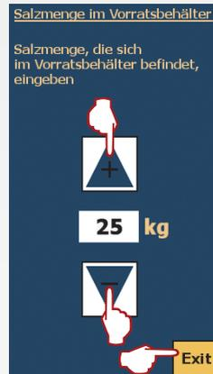
17. Geben Sie die eingefüllte Salzmenge ein (kg). Bestätigen Sie den Wert mit „Exit“. Anschließend wird im Display der Salzvorrat angezeigt (noch verfügbare Menge in Wochen). **Hinweis:** Diese Angabe stellt nur einen Richtwert dar! Danach wird die Grundanzeige des Displays wieder erreicht.
