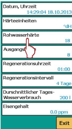
6. Wechseln Sie mit zum Punkt „Rohwasserhärte“ aus.
