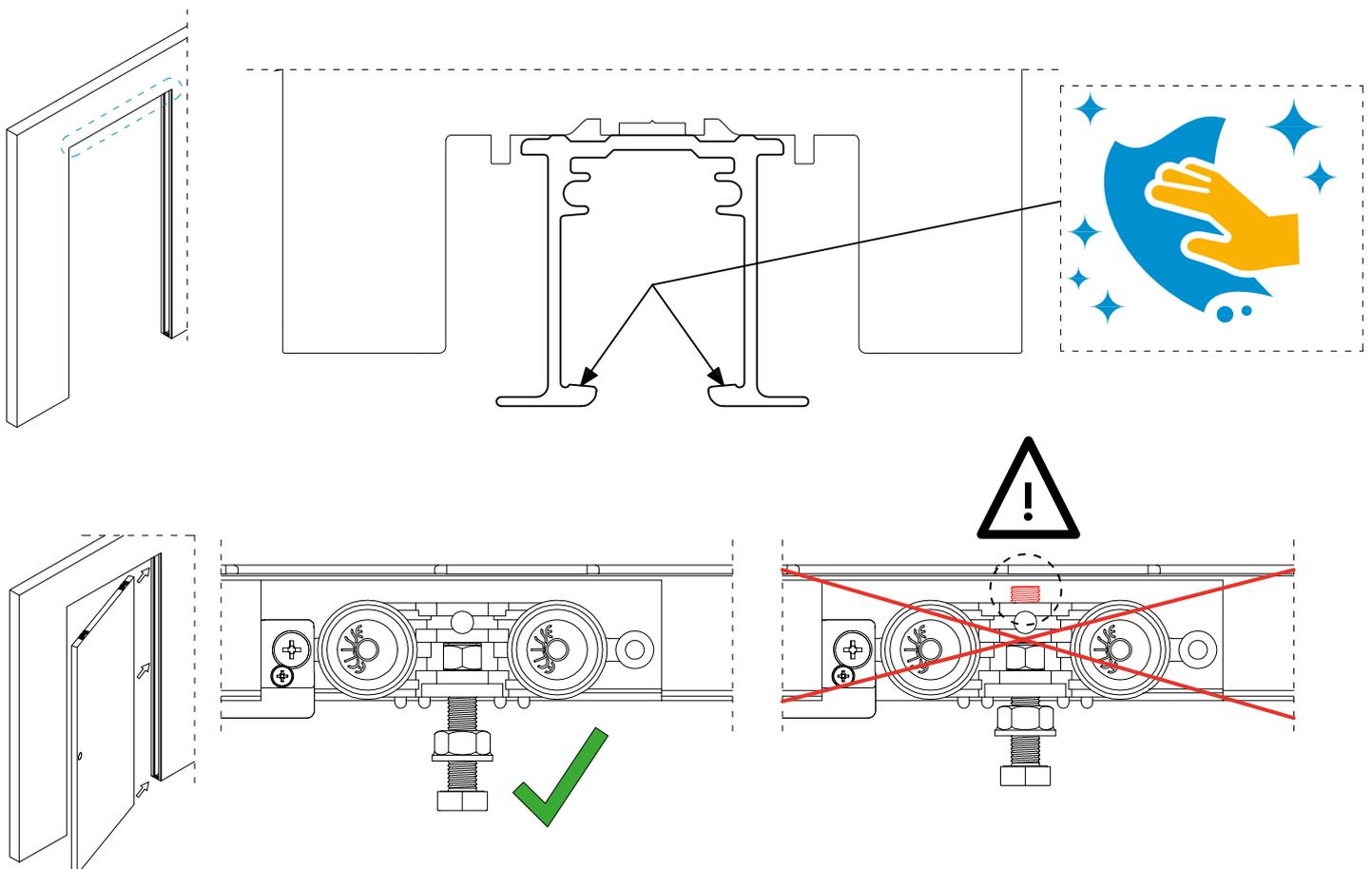
**6a Variante Einzelfügel:** Fixieren Sie den Mitnehmer C provisorisch mit 35 cm Abstand zum Anschlag. Schließen Sie danach die Tür soweit wie möglich, es wird ein Spalt bleiben.
