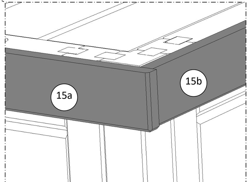
SCHNITT DETAIL BEFESTIGUNG DER ABDECKLEISTEN
