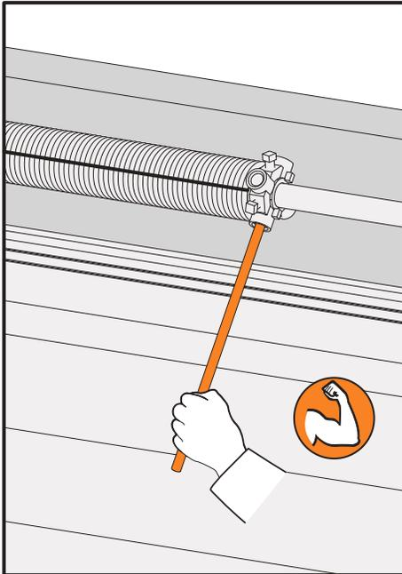
6.1.2 Die erste Torsionsstange um 1/4 Umdrehung drehen, so dass die Feder Spannung hat.
