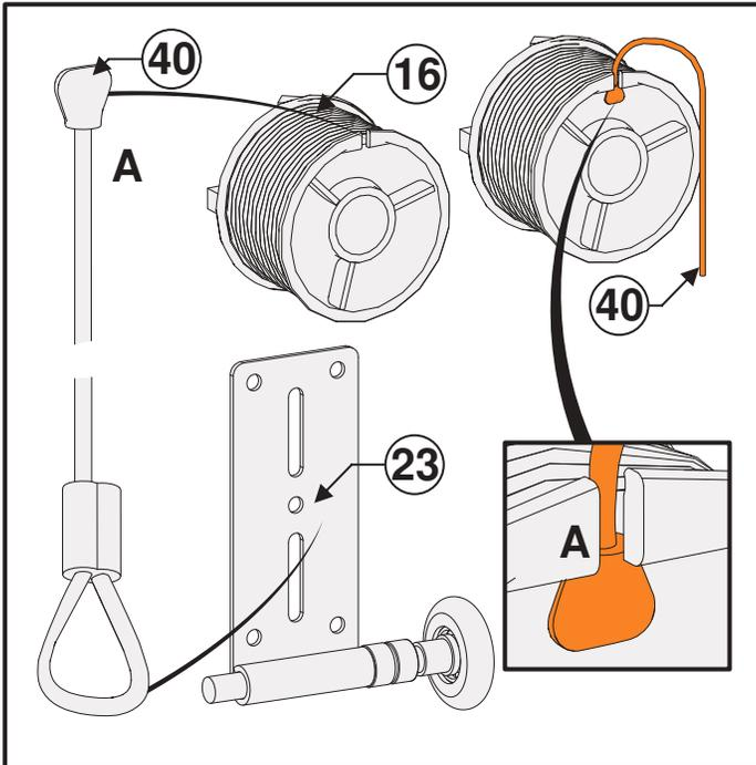
**5.2A** - Die Welle mit einer Presszange blockieren, wie auf Abb. angezeigt. Das Stahlseil (40) um die Trommel (16) wickeln, bis es Spannung hat.
