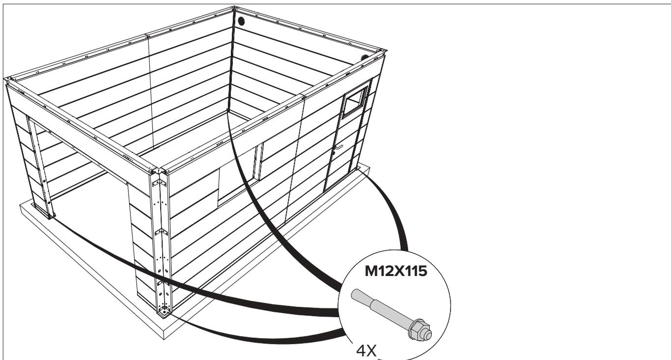
Exemple donné pour un sous-sol en béton. Fixer l'abri de jardin dans les règles de l'art.
