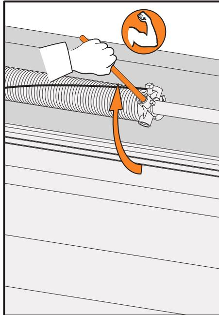
6.1.3 Die zweite Pressstange an der Endkappe der Feder anbringen
