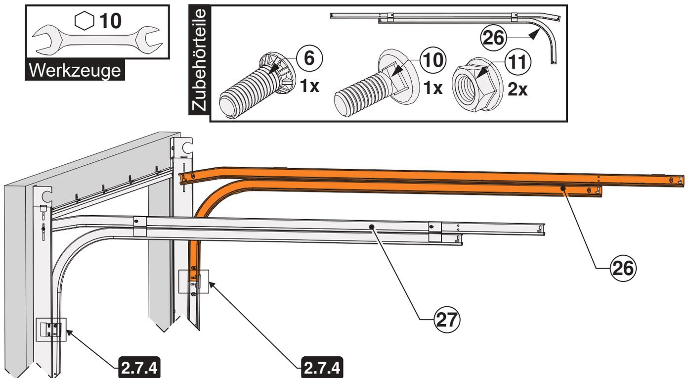
2.6.4 Die vertikale Führungsschiene mit der Verbindungsplatte (31 und 32) und der horizontalen Schiene ausrichten (26 und 27). Mit einer Zange festklemmen, so daß die Führungsrollen beim auf - und abrollen nicht an dem Verbindungsstück herauspringen.
