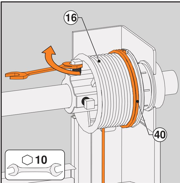
**5.4A** - Die Welle mit einer Presszange festhalten, damit das Stahlseil gespannt bleibt.
