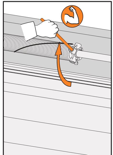
6.1.7 Die Schritte 3 bis 6 wiederholen, so dass die Feder die angezeigte Drehzahl wie auf dem CE-Etikett hat.
