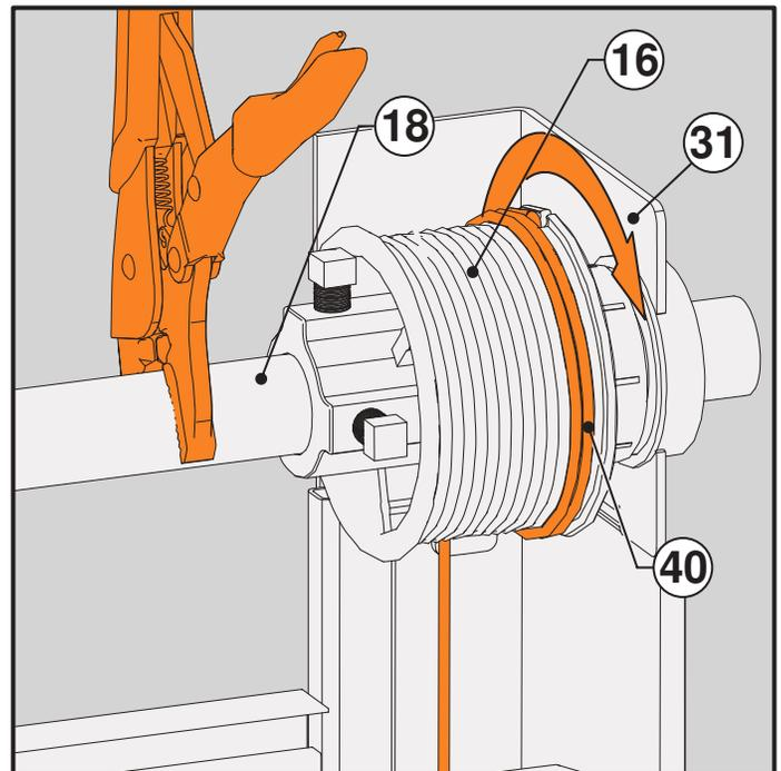
**5.5A** - Die Schritte für das zweite Stahlseil und Trommel (19) wiederholen. Überprüfen, ob beide Seile richtig am Schlitz angebracht sind.
