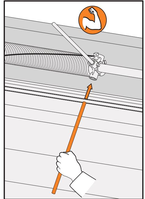
6.1.4 Die Spannung der Feder mit der zweiten Stange halten.
