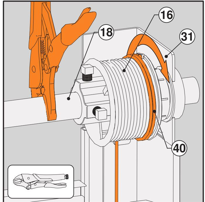
**5.3A** - Die Trommel (16) gegen die Laufrollen anbringen und beide Schrauben, wie auf Abb. angezeigt, festschrauben.
