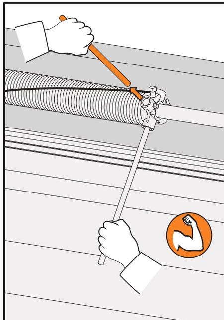
6.1.6 Die zweite Stange um 1/4 Umdrehung drehen, so dass die Feder mehr Spannung hat.
