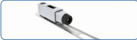
Der PTO arbeitet mit einer Druckfeder und wird in das hintere Ende der Laufschiene montiert. Mit ihm lassen sich Schiebetüren, die bündig in die Wand einfahren, mit einem kleinen Schubs auf das Türblatt komfortabel aus der Box holen. Ein Stirnziehgriff wird nicht mehr benötigt.
