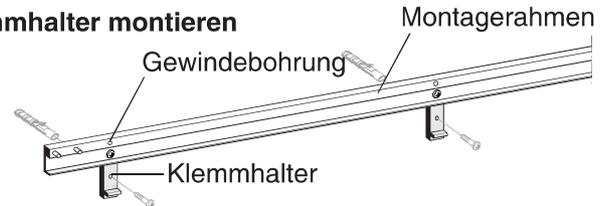
**Befestigungsschrauben (M8; SW 6 mm)**
