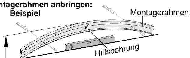
**Bei Wandunebenheiten Befestigungspunkte des Montagerahmens hinterfütern!**
