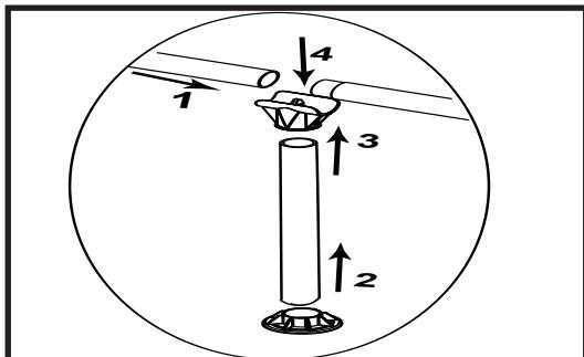
1. Montieren Sie die horizontalen Stangen.
