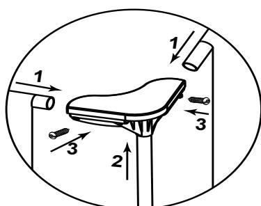
1. Použijte spojovací konec L-SPOJKY pro spojení sousedních horizontálních trubek.
