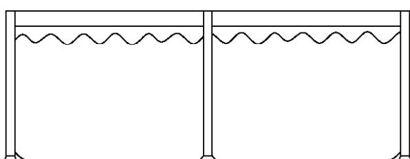
1. Asigurați-vă că raccordul de scurgere este bine fixat și capacul este bine poziționat. Începeți umplerea piscinei cu apă. După ce baza este acoperită cu aproximativ 1 inch (1 inch = 2,54 cm) de apă, opriți umplerea și neteziți faldurile de pe fundul piscinei. Împingeți peretele exterior de sub marginea superioară în jurul bazei bazinului, în aşa fel încât umplerea să fie uniformă.
