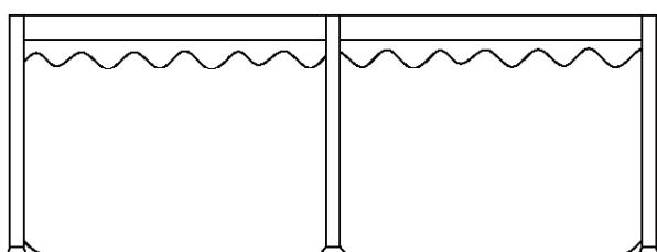
1. Zorg ervoor dat de afvoerfitting goed is ingestoken en dat de dop is geplaatst. Begin het zwembad te vullen met water. Nadat zich ongeveer 2,5 cm water op de bodem heeft verzameld, stopt u met vullen en wrijft u rimpels in de bodem van het zwembad glad. Trek de buitenwand naar buiten vanaf de bovenrand rond de hele bodem van het zwembad, zodat het gelijkmatig opvult.
