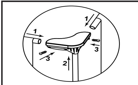
1. Utilizați capătul de conectare al îmbinării în L, pentru a conecta tuburile orizontale adiacente.
