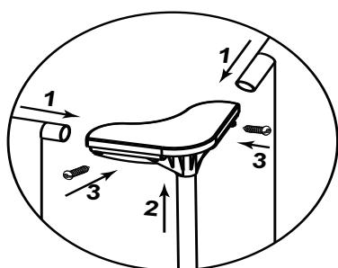
1. Použite spojovací koniec L-SPOJKY pre spojenie susedných horizontálnych rúrok.
