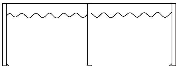
1. Zaistite, aby vypúšťacia armatúra bola bezpečne zastrčená a aby bola nasadená krytka. Začnite napúštať vodu do bazéna. Hneď ako hladina vody dosiahne výšky približne 2,5 cm, prestaňte napúštať vodu a vyhľadajte vrásy z dna bazéna. Vytiahnite vonkajšiu stenu smerom von zospodu vrchného kruhu, všade okolo dna bazéna, aby sa bazén naplnil rovnomerne.
