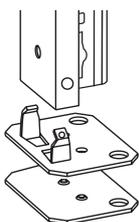
Unterlegplatte für Doppel-Klemmfuß
