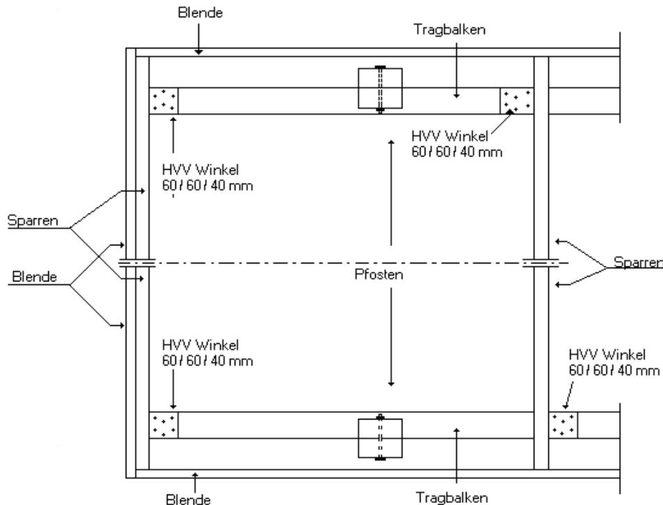
Der Sparren am hinteren Ende des Carports wird in der Regel 4-6 cm vom Tragbalken zurück gesetzt, damit die Montage einer Dachrinne möglich ist (nicht im Lieferumfang enthalten). Das Maß ist auf die tatsächlich verwendete Dachrinnenanlage abzustimmen.
