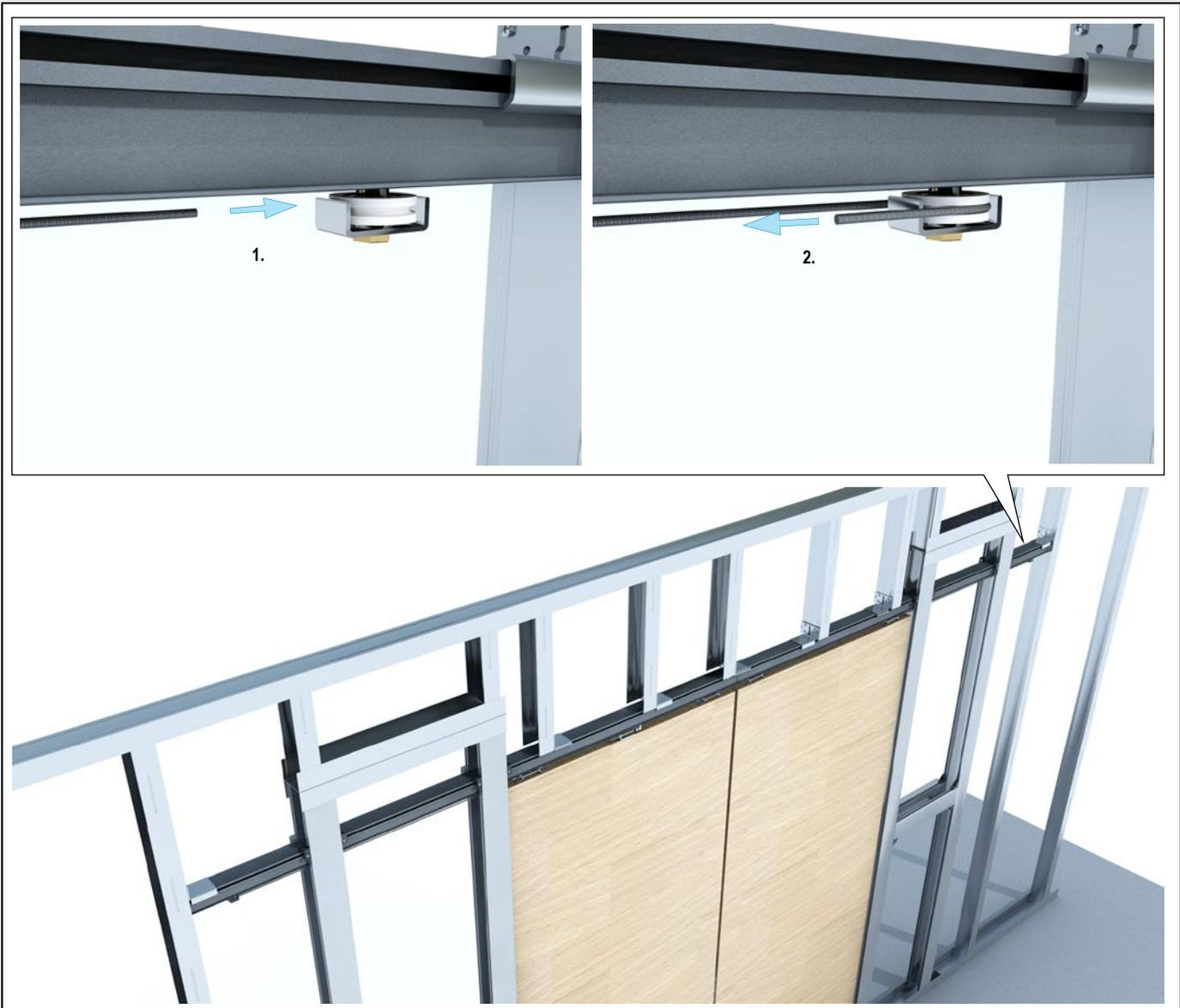
11 Seilzug an der Anbindung am linken Türblatt festschrauben.
